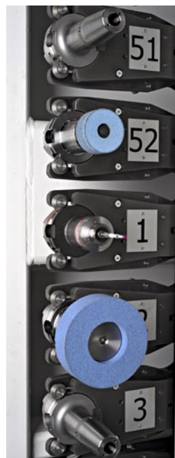
Пример устройства смены инструмента для 52-х позиций и процесса смены, для комплектной обработки сложных деталей только за один установ
